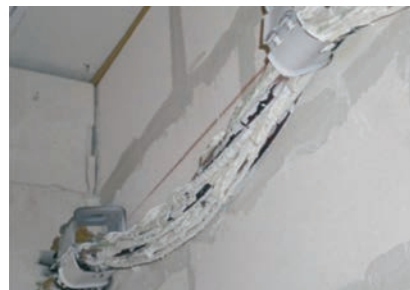
Bakreni vodiči ostaju razdvojeni, ne dolazi do kratkog spoja.
