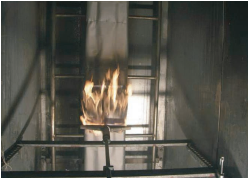
Paljenje protupožarnih bandaža otvorenim plamenom
