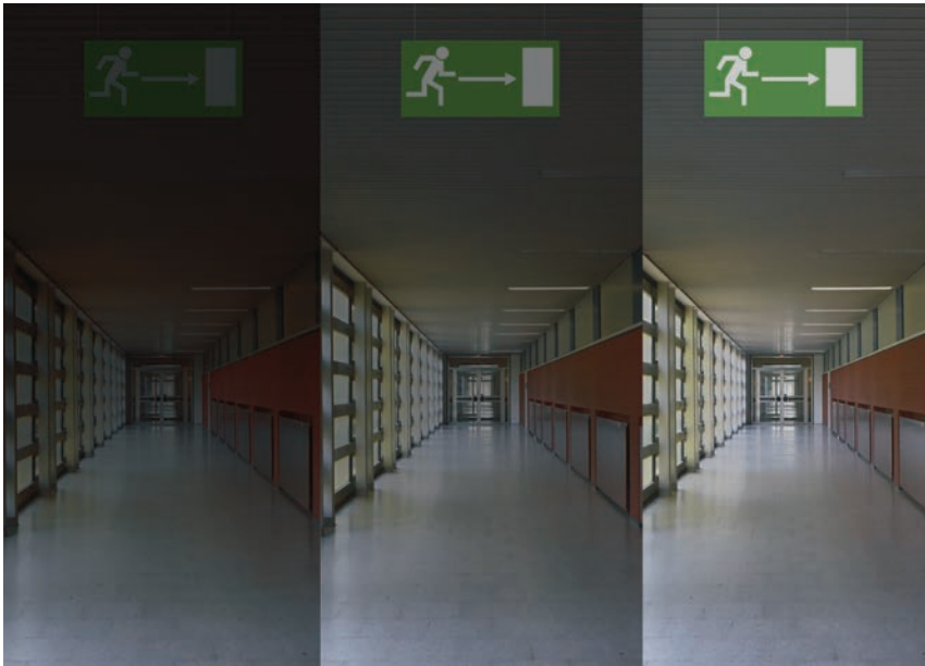
Ponašanje kabela u slučaju požara: s PVC izolacijom, s niskom emisijom dima, bez halogena (s lijeva na desno)
