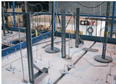
Mjerni uređaji na peći za ispitivanje
