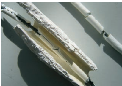
Kabel za očuvanje funkcije s izolacijskim slojem
