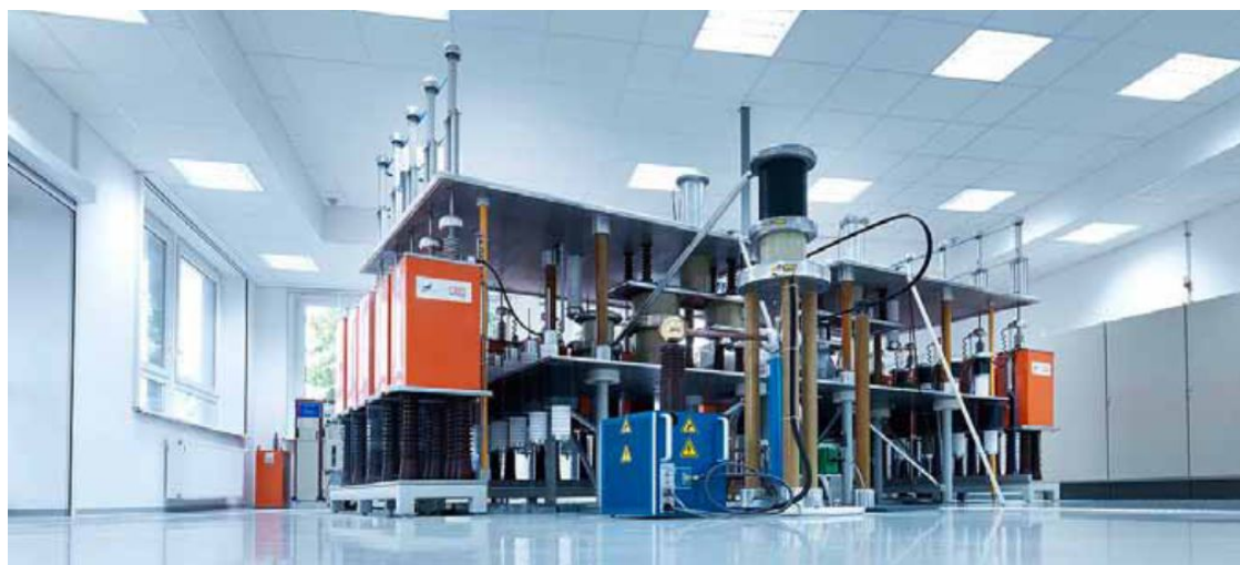
Slika 6. Generator struje munje u BET centru
