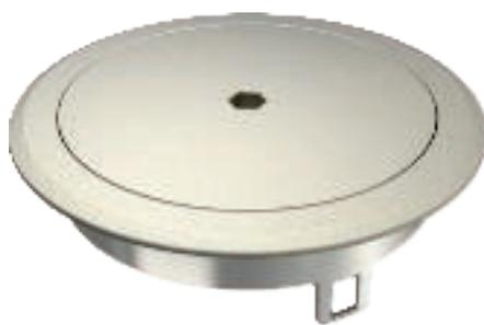
Slijepi poklopac s imbus zasunom za podnu kutiju GES R2, za ugradnju u ugradnu kutiju MT R2. Poklopac se može koristiti i za izvod kabela. Podna kutija u zatvorenom stanju ispunjava zahtjeve norme HRN EN 50085-2-2 za mokro održavane podove.
